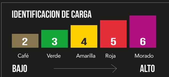
4. Según la dureza de los materiales base, existen diferentes niveles de potencia que son identificados por su color y referencia. Al incrementar el nivel de potencia, incrementa el poder de la carga.
